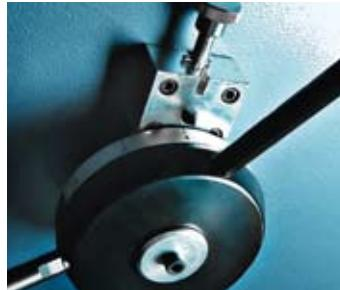
**ОДНОТОЧЕЧНАЯ РЕГУЛИРОВКА ЗАЗОРА МЕЖДУ ЛЕЗВИЯМИ**
