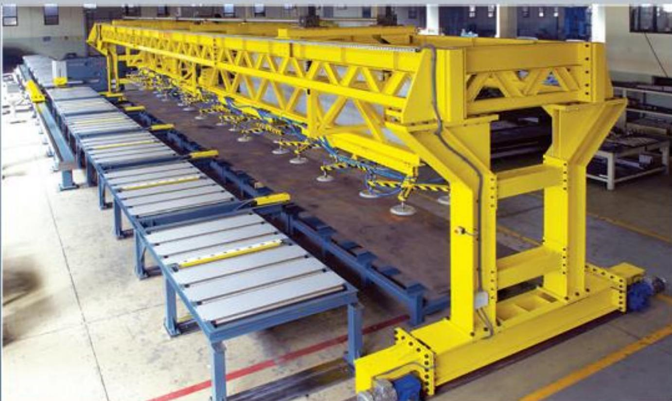
*Автоматическая линия пробивки на производстве световых столбов с системой загрузки и выгрузки*
