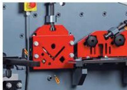
*На этой станции производится вырубка прямоугольных и треугольных отверстий*
