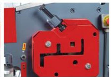
*Станция резки уголков с двумя клише. На этой станции можно осуществлять резку профилей под углом*
