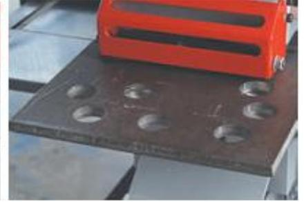
*Пробивка плоских заготовок*
