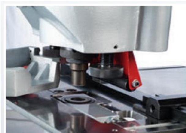
Станция пробивки стандартно оснащена быстросъемными держателями матрицы и пуансона, а также пружинным съёмником
