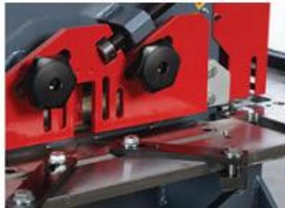
*Эта станция позволяет резать различные профили*
