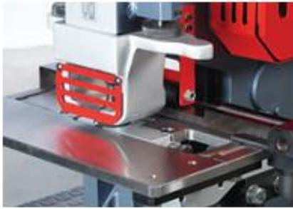
*Пробивная станция имеет максимальные пределы 27x13 и 18x18*
